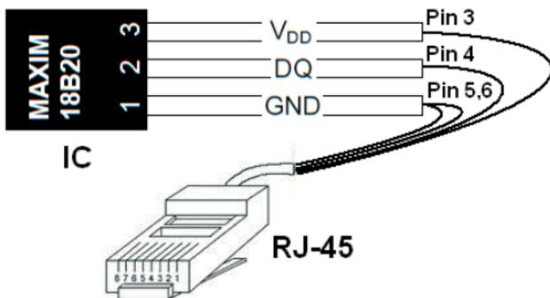
Der Fühler kann optional bis zu 50 Meter mit einem Netzkabel und einem 2 x RJ45-Adapter verlängert werden. (siehe nachfolgende Abb.)
